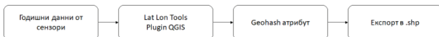
Фиг. 4. Процедура за първична обработка на отворените данни от AirTube DataBank за гр. София.
